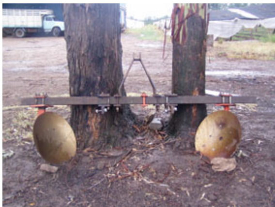
Vista de un doble disco alomador
