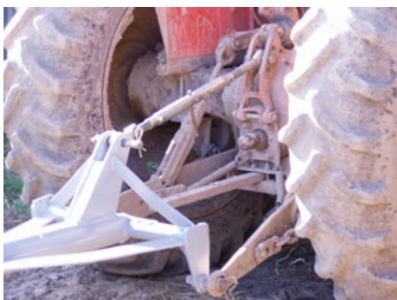
Vista del sistema de tres puntos en tractor articulado de 120 y 23 HP
