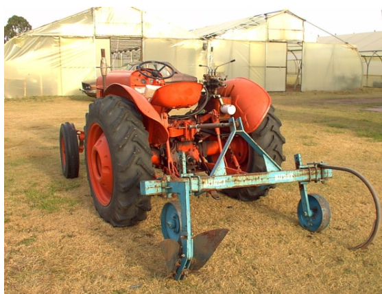
Tractor con barra de herramientas
