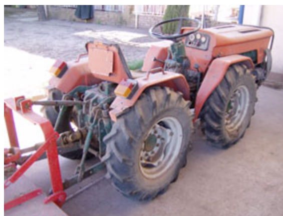
Vista del sistema de tres puntos en tractor articulado de 120 y 23 HP
