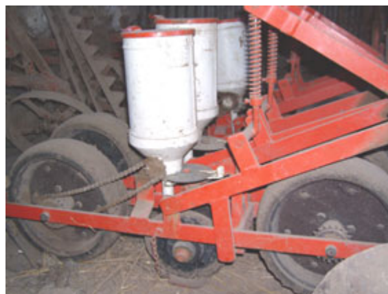
Cuerpo de siembra de una Planet montada
